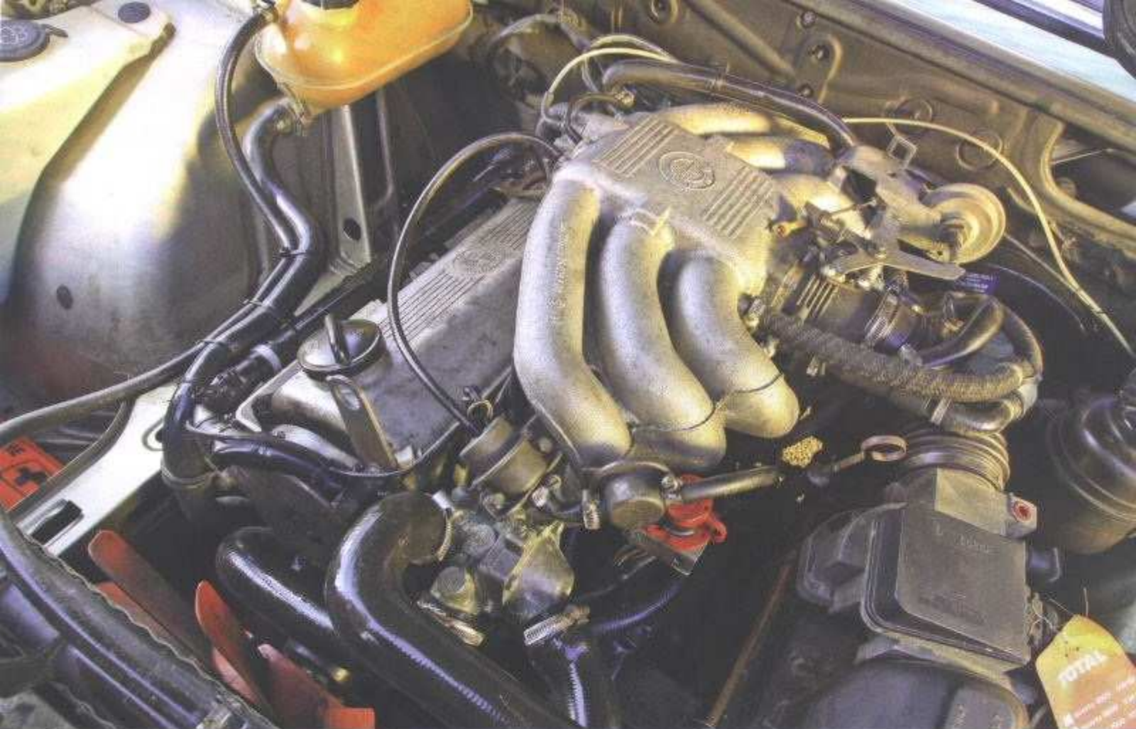
Das Saugrohrgeweh verrät den Einspritzmotor. Der kleine Sechszylinder mit Zahnriemen diente auch als Basis des 525 Eta und für den dynamischen Diesel 524 td
