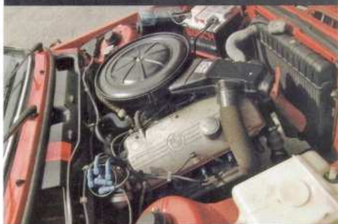
Der legendäre M10-Vierzylinder hat im späten 316 1,8 Liter Inhalt
