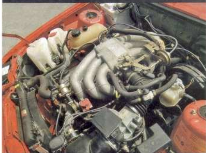
Die LE-Jetronic versorgt den Zahnriemen-Sechszylinder
