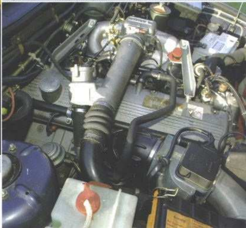
Turbo-Ofenrohr über dem Jahrhundert-Sechszylinder. Motronic und Ladeluftkühlung zeugen von hohem Aufwand. Die Metallschienen am Luftsammler stören das Bild
